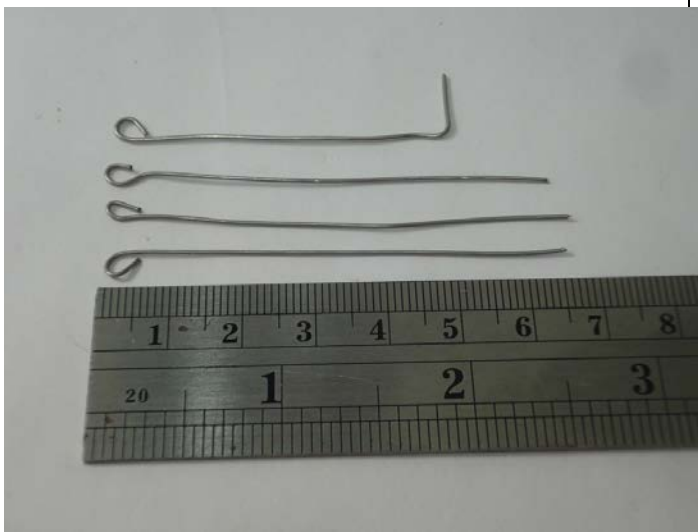
STEP7. 剪 4 條鐵線，使用尖嘴鉗折彎
