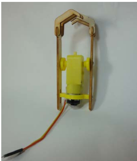
攀爬的猴子，擺動滑塊曲柄機構
