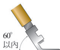
圖 4-1.21 壓接端子彎曲要點
