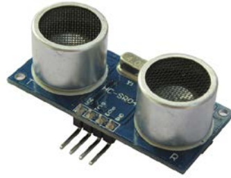
圖 2-5：HC-SR04 超音波感測器模組
