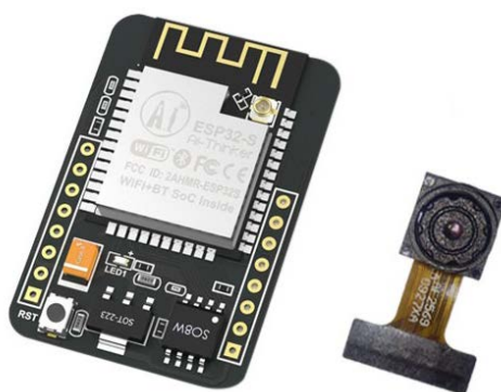
圖 2-2：ESP32-CAM 開發板及 OV2640 攝像頭
